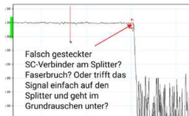
Abbildung 2: OTDR-Kurve für den Anschlussbereich
