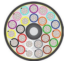
Beispiel für ein Kabel mit 3456 Fasern.
