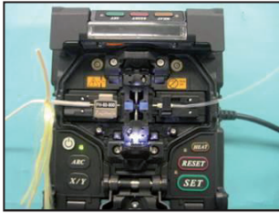
1. Kabel und Stecker in das Spleissgerät einlegen und starten.
