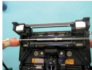
3. In die Heizkammer einlegen und das Röhrchen schrumpfen.
