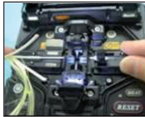
2. Spleisschutzröhrchen über den Spleisspunkt schieben.
