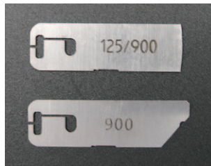
Zentrierbacke (oben) und Messer-Kombination zum Abmanteln einer 900/125µm-Faser.
