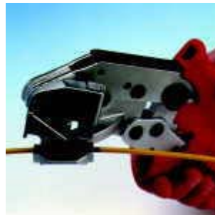
Einlegen der Bündelader
