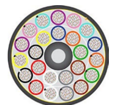
Beispiel für ein Kabel mit 3456 Fasern.
