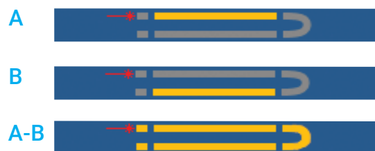
Mit dem Loopback-Modus und der Option iLOOP der iOLM-Anwendung können zwei Glasfasern gleichzeitig gemessen werden. Es ist möglich, nur die A-Faser, nur die B-Faser oder die gesamte Faserstrecke A-B einschließlich Schleife anzuzeigen.
