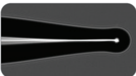
Getapertes Werkstück mit kleiner Kugel am Ende
