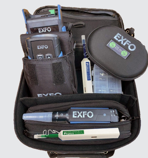
NE 4 Set, für Abnahmemessungen auch für NE 3 geeignet. EXFO DX1, EX1 & Mikroskop.
