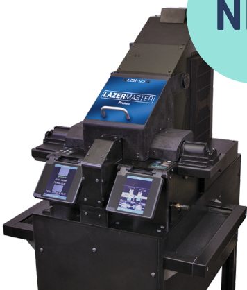
LZM-125A+ Panda- und LDF- Spleissgerät bis 2300µm mit Faserendflächenbetrachtung und neuen Funktionen für Cladding Light Strippers u.a.
