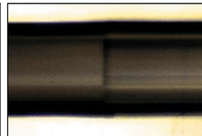
Mit sehr geringer Laserleistung gespleißte PCF-Faser. Der Hohlkern blieb unbeschädigt.
