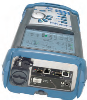
Das 10 Gigabit Ethernet-Testmodul FTB-8510G Packet Blazer ist in die Kompaktplattform FTB-200 einsetzbar. Hier ebenfalls in der Plattform abgebildet ist das Ethernet-Testmodul FTB-8510B.
