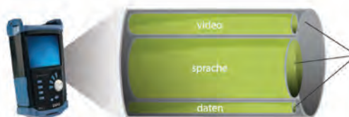
Für jeden Dienst werden alle SLA-Parameter (Durchsatz, Latenzzeit, Rahmenverlust, Jitter, OOS, Gut/Schlecht-Ergebnis) gemessen.
