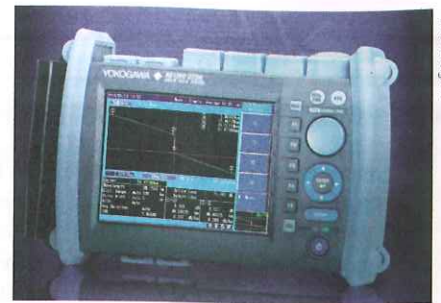
Yokogawa setzt bei seinem optischen Feldtestgerät Micro-OTDR AQ1200 auf hohe Empfindlichkeit und Flexibilität.
